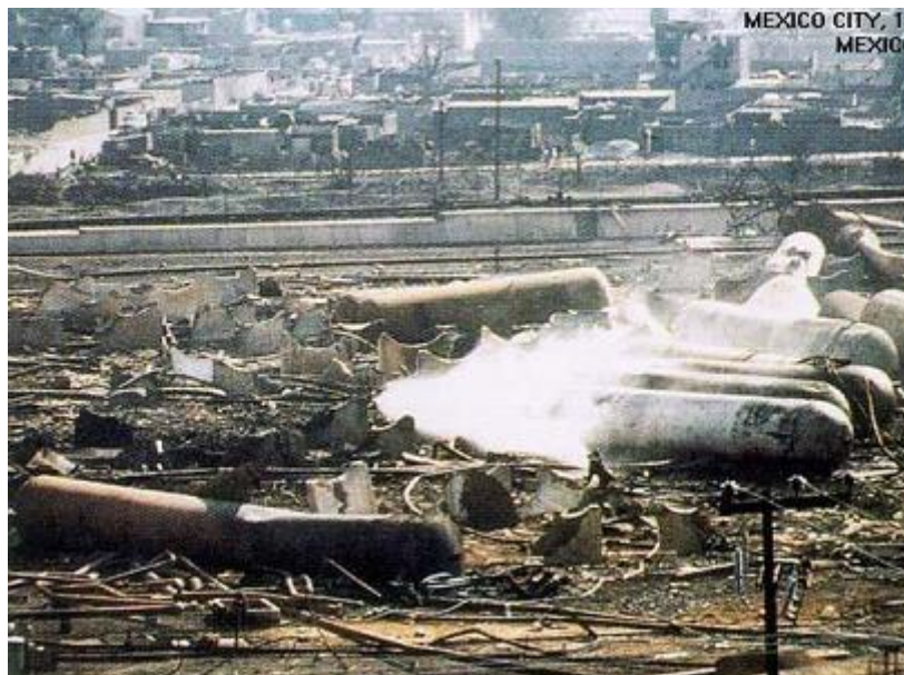
Hình 4.3: Hình ảnh nổ dây chuyền bồn gas công nghiệp tại Mexico năm 1984 làm chết 500 người và 30.000 người phải sơ tán do nhà cửa bị phá hủy
