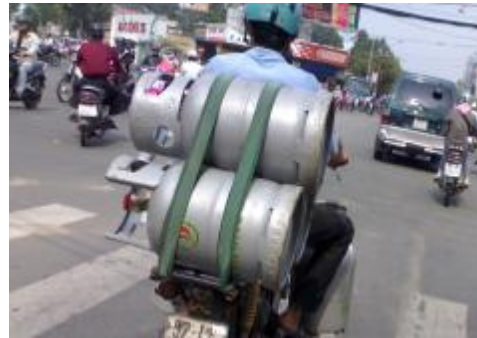
Hình 4.2: Hình ảnh chuyên chở gas không đúng quy định (theo quy định, xe gắn máy chỉ được chở một chai gas, đặt thẳng đứng)
